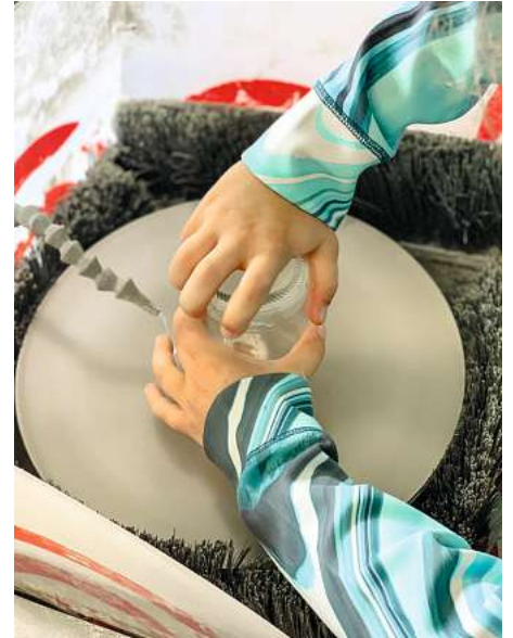
Das Feinschleifen der Glasränder erfolgt auf einer drehenden Diamantschleifscheibe.
