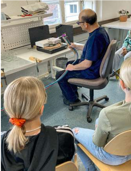
Auf dem drehbaren Plattenteller werden die Glasränder flammpoliert.
