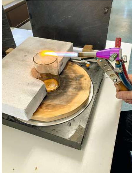
Auf dem drehbaren Plattenteller werden die Glasränder flammpoliert.
